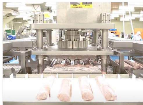
2 ケーシング剥離からスライサーへの投入までを自動化
