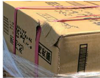
バンドの食い込みによる破損
