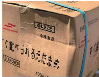
角の潰れによる破損
