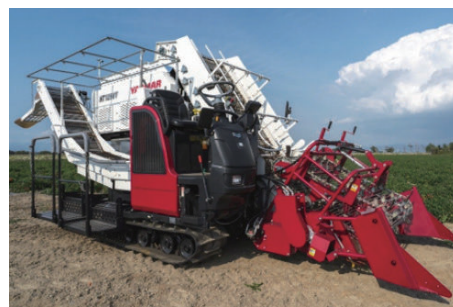
加工用トマト収穫機 「Kagome Tomato Harvester (KTH)」
