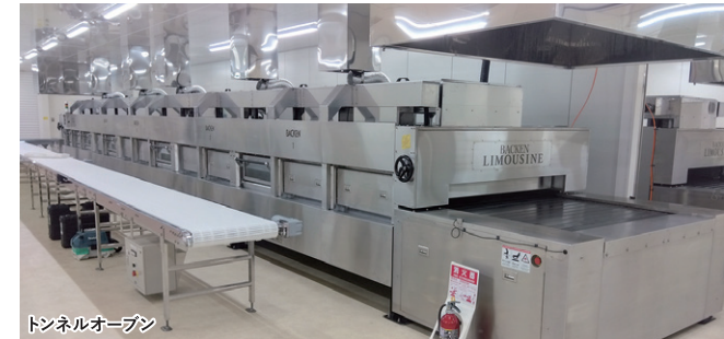
トンネルオープン
